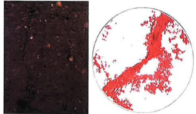
Abb. 1: Nachweis der Risserzeugung durch pneumatisches Fracturing mittels Computertomografie, Quelle: GUB Lauta; GE Sensing und Inspection Technologies Wunstorf
